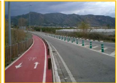
4) Plataforma tipo carril bici -bidireccional con protección. (Tipo-4)
